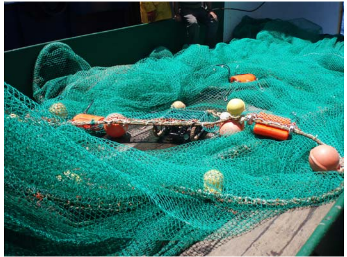
Rede utilizada na campanha de arrasto, com a câmara de vídeo (ao centro) e outros sensores.
